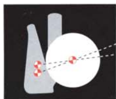
▲DCIオーバーサイズの重心は高い打ち出し角を得るために、DCIミッドよりも、やや下方に位置している。
