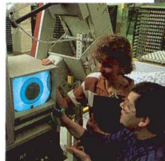
◀X線による中心チェックをはじめ、32の検査を通過してはじめて世に送り出される。厳格な品質管理があるから、プロたちは信頼してツアーを戦える。
