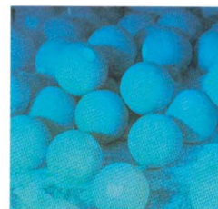
◀凍らせたセンターコアに2ステージ糸巻き法というタイトリスト独自の製法でゴムを巻く。最高のフィーリングと加速力がここから生まれる。
